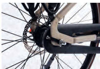
Kleine 7-Gang-Freilaufnabe, 180 mm Bremsscheibe, XL-Kettenschutz.
