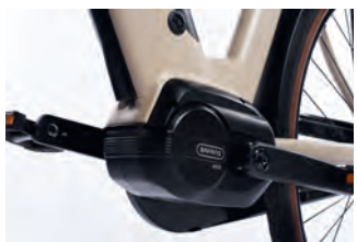
Der Bafang M420 überzeugt: kultiviert, ausreichend schubstark.
